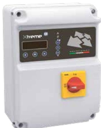
XTREME – пульт управления для прямого запуска 1 одно- или трехфазного насоса с защитой от сухого хода, по cos-φ и по минимальному току, с дистанционным управлением, через gsm и программное приложение. Устройство должно быть установлено в закрытом, хорошо проветриваемом, безопасном помещении. Работает при температуре не выше +40 °С и не ниже -5 °С (относительная влажность 50% при 40 °С неконденс.)
